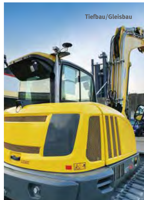
Kettenbagger mit LogPos-GPS-Ausrüstung
